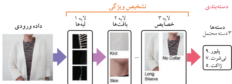
شکل ۶-۴. یک مثال فرضی و ساده از نحوه استخراج ویژگی‌های شبکه‌های عصبی پیچشی برای طبقه‌بندی تصویر یک لباس
