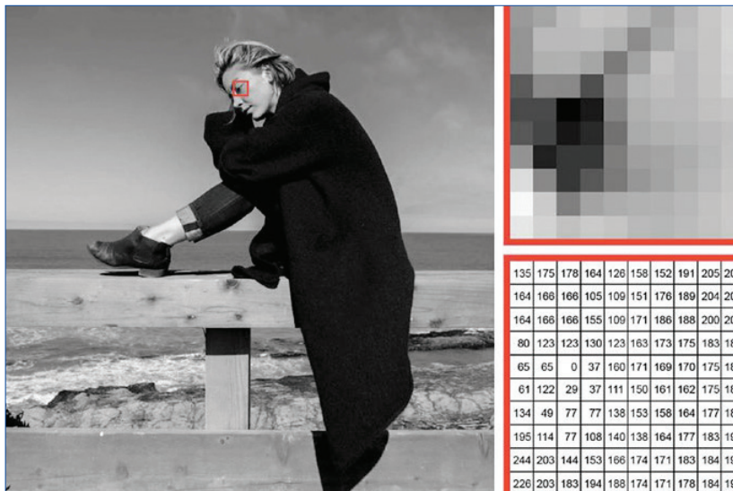
شکل ۳-۳. سمت چپ، تصویر مایکل روبین. بالا سمت راست، قطعه بزرگ شده تصویر. پایین سمت راست، ارزش به ازای هر پیکسل
